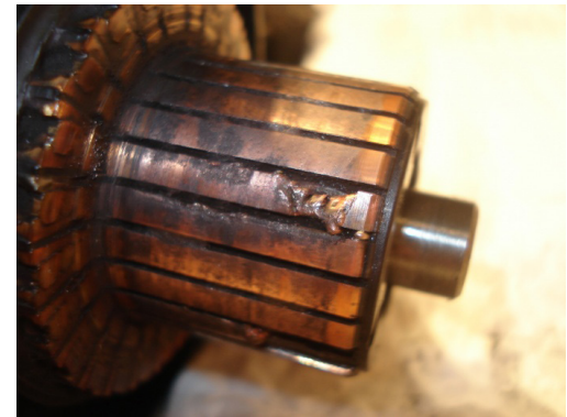
Conmutador del motor de arranque quemado por uso excesivo del motor de arranque
